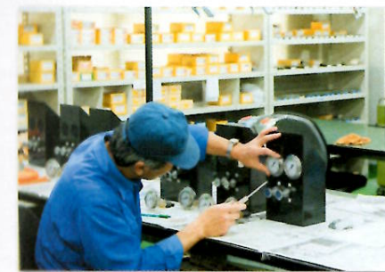
高精度が求められる油圧メーターを丁寧に取り付ける
